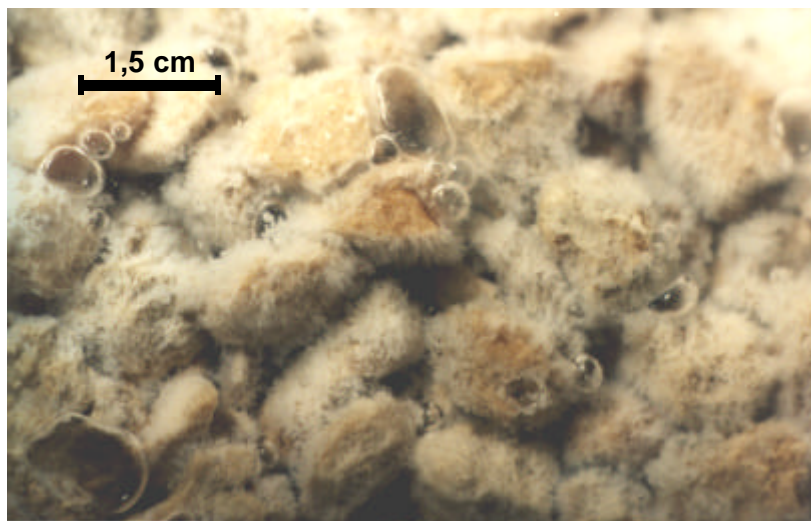
Abb. 8: Ausfällungen von Aluminiumhydroxid auf der Oberfläche der Kalksteine nach 6 Tagen
